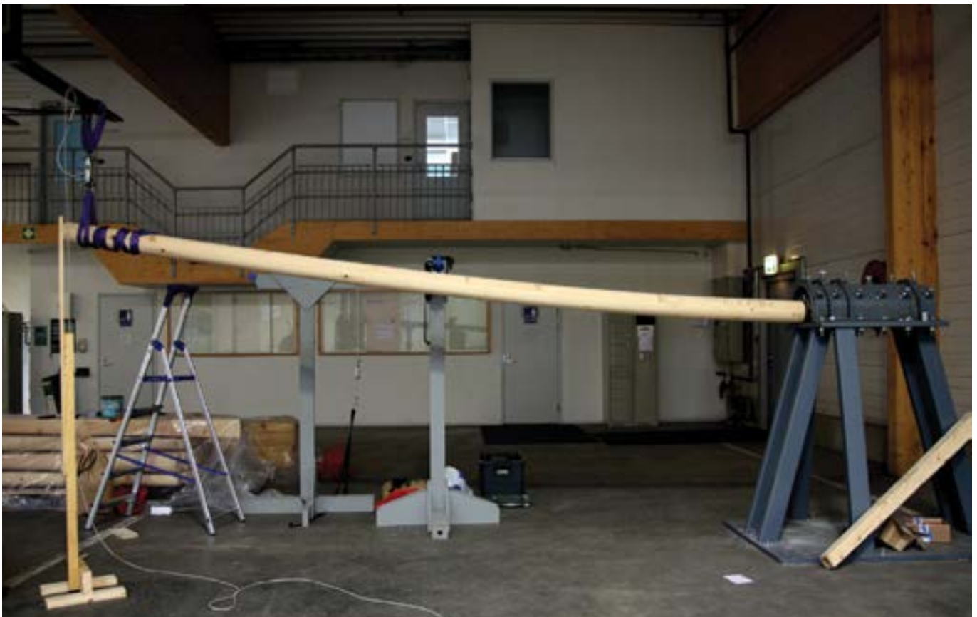
Sterkte test houten lichtmast
